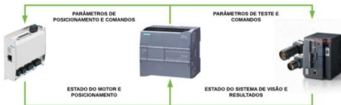
**Figura 2.** Troca de informações e comandos entre os componentes do sistema.
