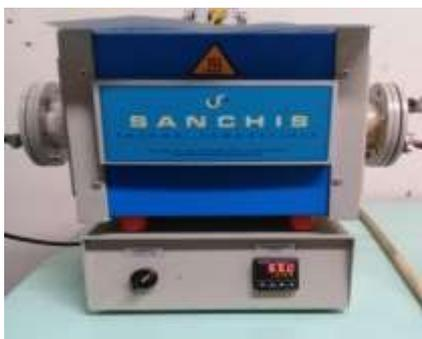
Figura 8. Forno para extração térmica (Autor).
