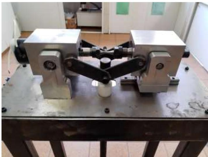
**Figura 6:** Equipamento para ensaio de fadiga por flexão rotativa.
