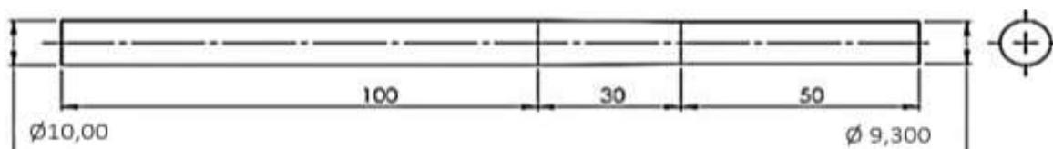
**Figura 2 Desenho 2D do corpo de prova**
