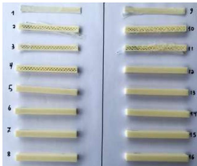
**Figura 5** - Corpos de prova obtidos com a impressão em ABS. FONTE: Próprio autor.
