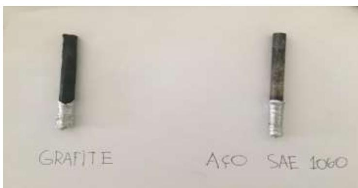
**Figura 5.** Hastes após agitação.
