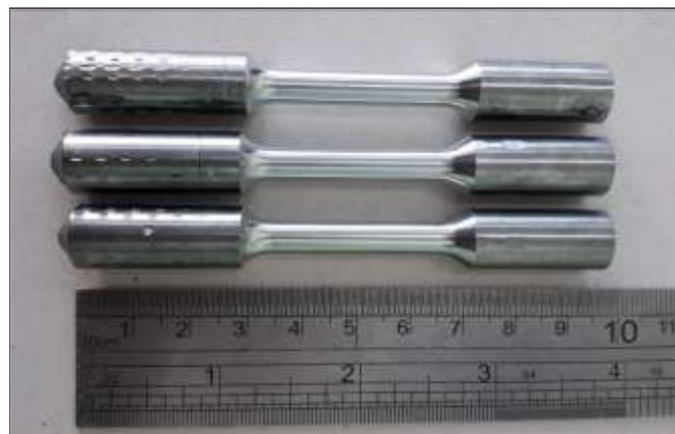
**Figura 2.** Corpos de prova.
