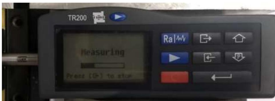
Figura 3. Rugosímetro digital portátil.
