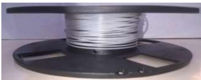
**Figura 2:** 5,85m de filamento de PEAD para impressão 3D obtido através da velocidade 4,5 rpm, com 1,75 mm de diâmetro.
