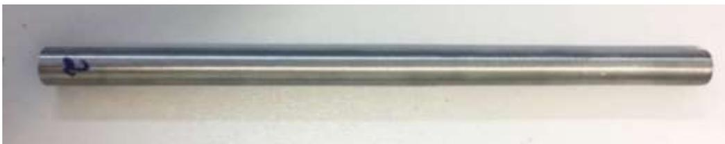
Figura 3 - Barra apontada e polida antes do processo de trefilação.
