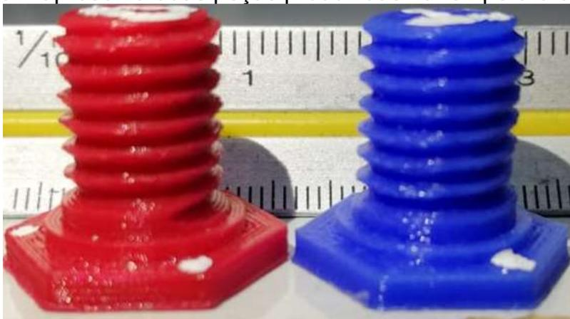
**Figura 7:** Ensaio da roscas M10 em PLA em 180 °C.
