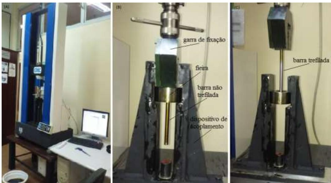
**Figura 5** - Máquina Universal de Ensaios e detalhe da fieira empregada
