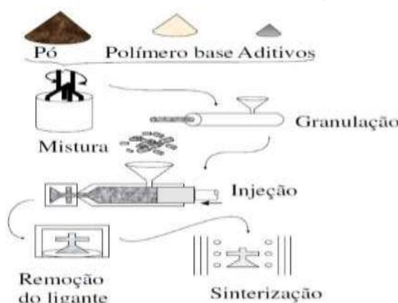
Figura 1. Fluxograma do processo de MPI, *Catto*<sup>(7)</sup>.
