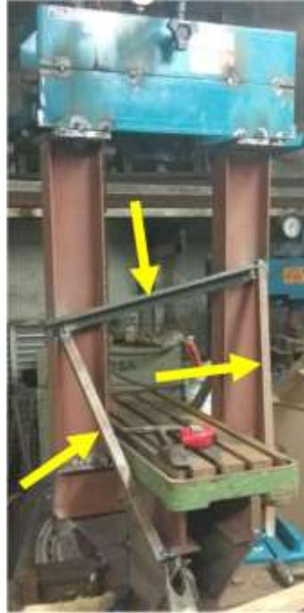
Figura 14. Travamento dos componentes para evitar a perda dos alinhamentos
