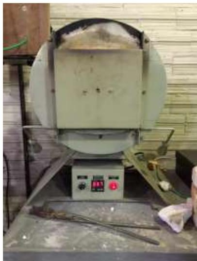
Figura 1. Forno resistivo com controle de temperatura.
