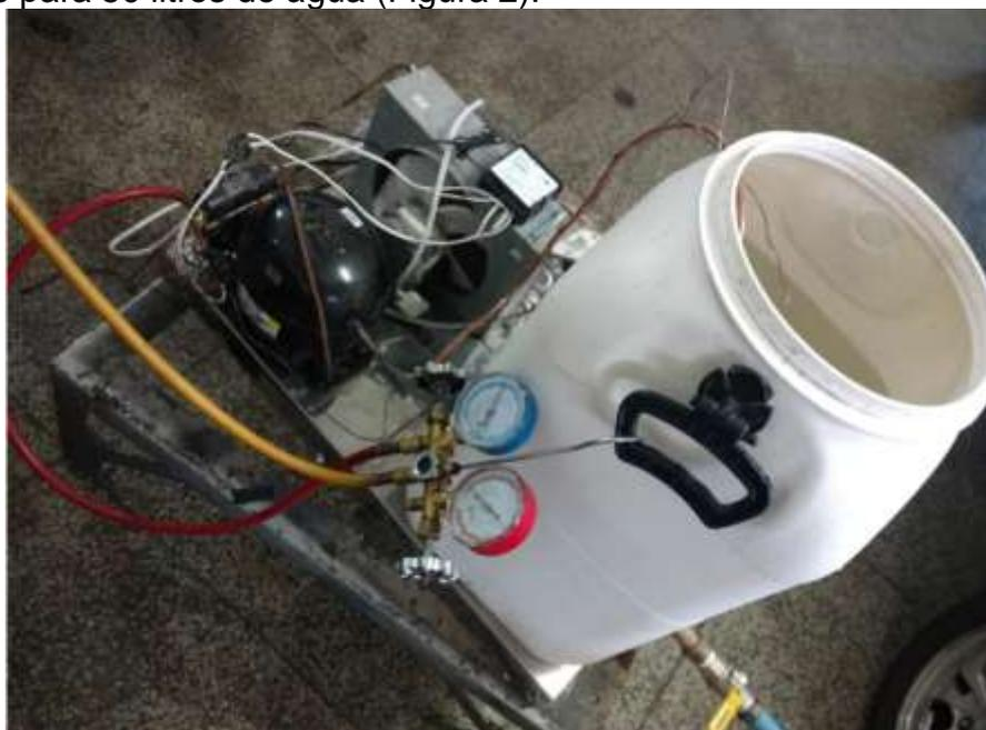
**Figura 2:** Montagem da central de água gelada.
