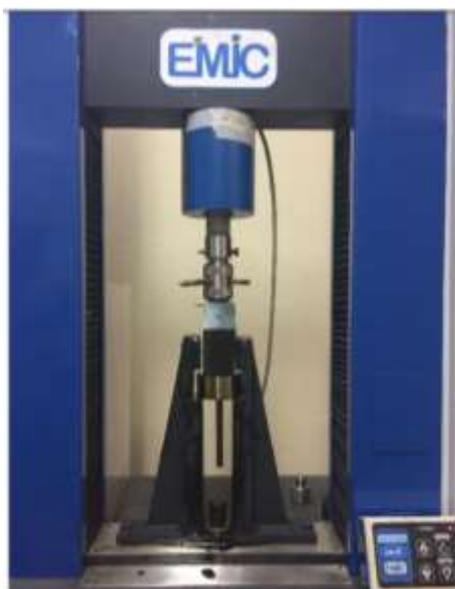
Figura 4 Máquina universal adaptada para ensaios de trefilação
