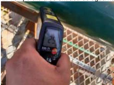
**Imagem 3.** Temperatura de saída de água do trocador
