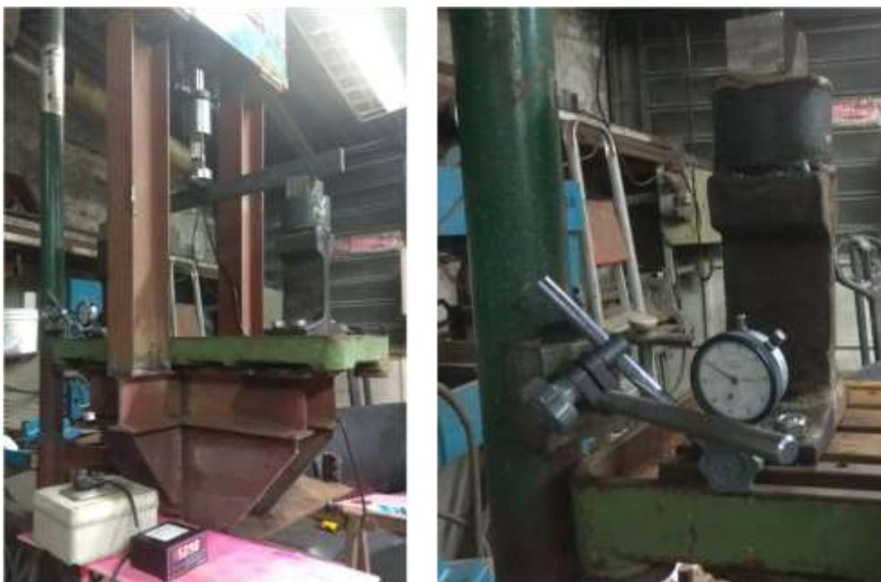
**Figura 12. Medição dos deslocamentos do equipamento**
