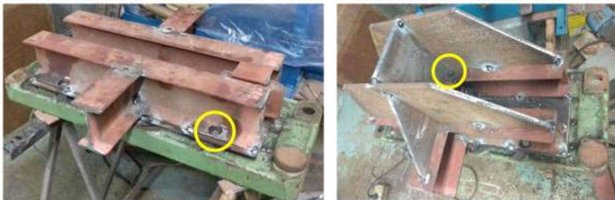
Figura 13. (a) Vigas da estrutura base; (b) Nervuras da estrutura base
