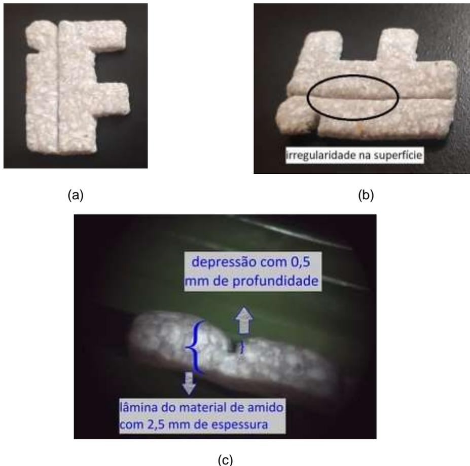
**Figura 7:** (a) visão superior da peça 3, (b) irregularidade na superfície da peça 3, (c) depressão formada na peça 3.
