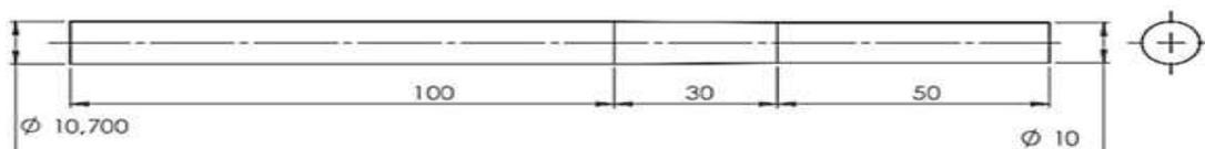
Figura 2. Desenho 2D dos corpos de prova.
