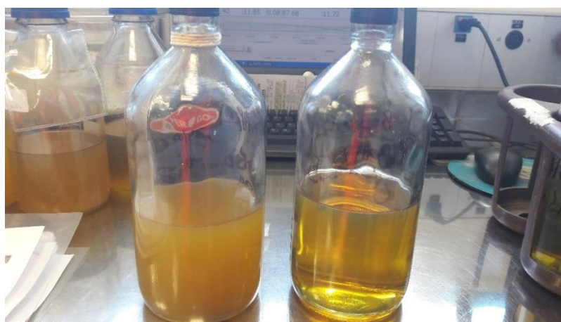
Figura 7: Bomba B-B3 Etapa 3 – Diferença de contaminação entre mancal LA e LOA
