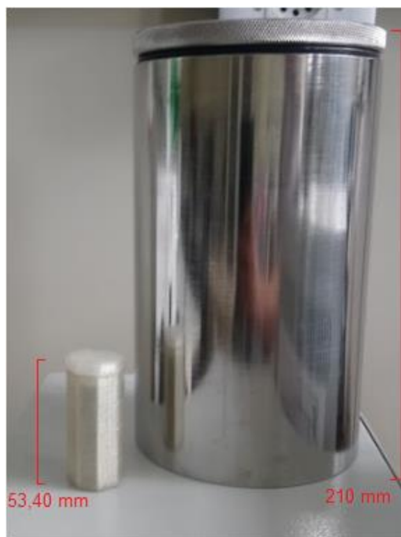
Figura 2. Comparação de tamanho entre tambor adaptado (E) e jarro original (D).
