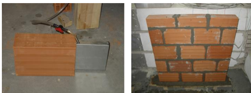
Figura 3. Preenchimento do tijolo com material de mudança de fase e amostra de parede (Vicente; Silva, 2014) (46) .
