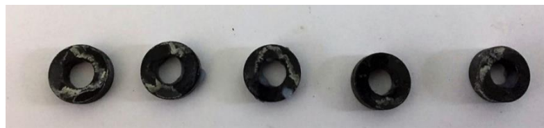
Figura 6 - Aço + fosfato de manganês + sabão.
