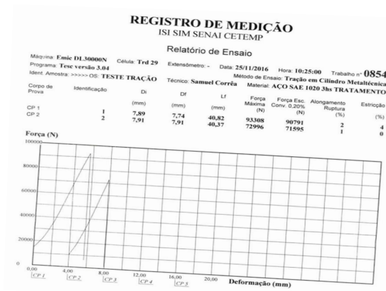
Figura 15 - Informações e curva do ensaio de tração em corpo de prova com 3 (três) horas de tratamento.
