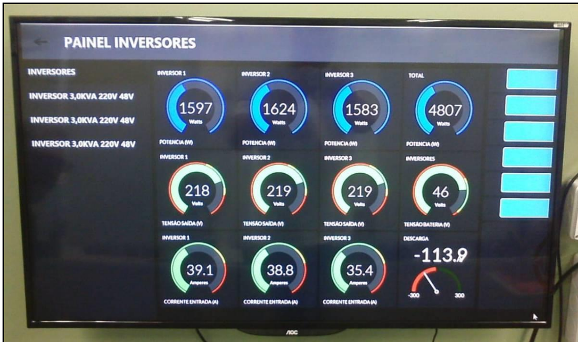
Figura 29 – Dados de Potência, Tensão e Corrente Elétricas mostrados na Tela da TV para – (a) Carga de 2,5 kW – (b) Carga de 5 kW
