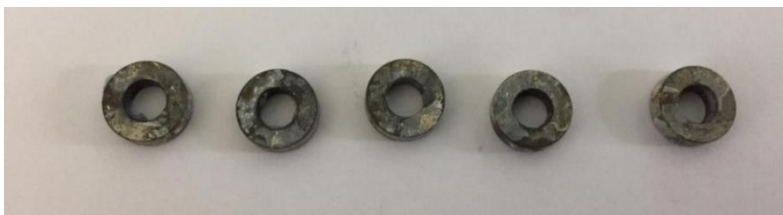
Figura 5 - Aço + fosfato de zinco + sabão.
