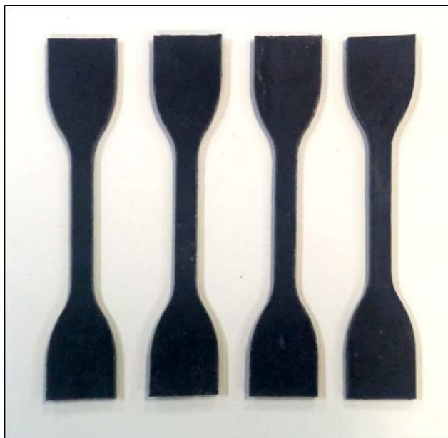
Figura 4. Corpos de prova para ensaio de tração.
