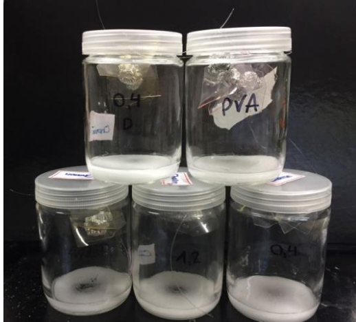
Figura 1. Sistema amostras + solução saturada de NaCl nos recipientes herméticos.
