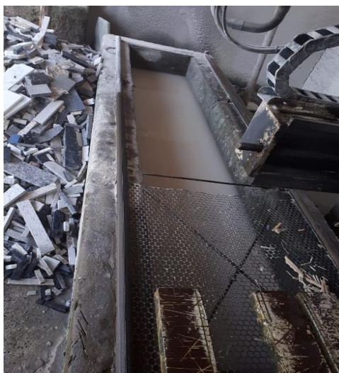
Figura 3: Tanque de decantação da “lama” do corte do mármore/granito
