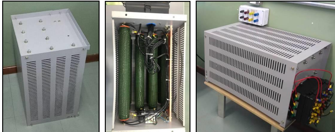
(a) (b) (c) Figura 24 – Banco de Cargas Resistivas – (a) Vista Externa – (b) Detalhe das Resistências Internas – (c) Com Borges para Conexões Externas
